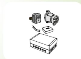
ECS 41 Grupa mieszanina ECS 41 umożliwia sterowanie kilkoma obiegami grzewczymi o różnych parametrach, na przykład w przypadku występowania w budynku ogrzewania mieszanego (grzejnikowo-we/podłogowe)
