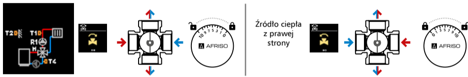
Rys. 13. Schemat z zaworem mieszającym 4-drogowym (ogrzewanie płaszczyznowe lub grzejnikowe) z aktywną funkcją ochrony temperatury powrotu.
