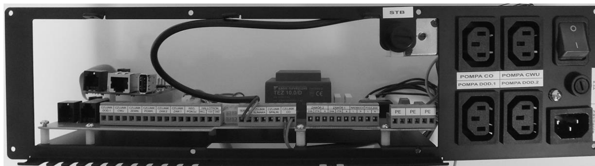
Rysunek 1 Listwa przyłączeniowa do zasilania urządzeń regulacyjnych (uwaga fot. przedstawia przykładowe rozmieszczenie podłączeń, szczegóły w dołączonej DTR sterownika).
