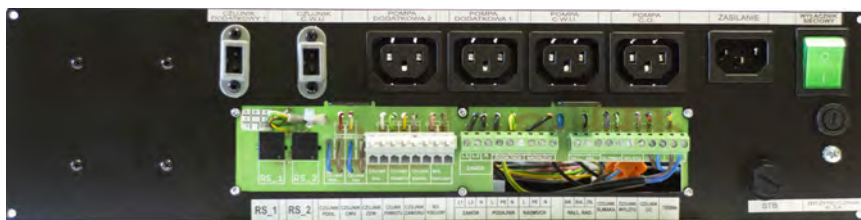
Rysunek 2 Listwa przyłączeniowa do zasilania urządzeń regulacyjnych (uwaga fot. przedstawia przykładowe rozmieszczenie podłączeń, szczegóły w dołączonej DTR sterownika).
