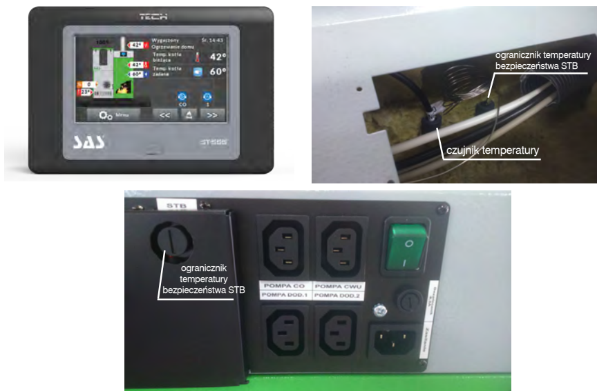
Rysunek 14 Lokalizacja ogranicznika temperatury bezpieczeństwa STB oraz czujnika temperatury
