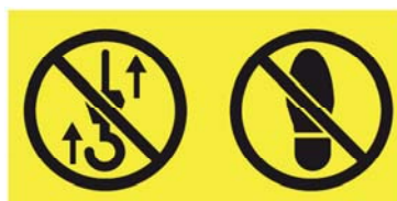
Rys. 5: Naklejki ostrzegawcze na rozdzielaczu
